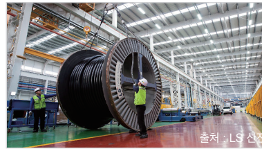
출처 : LS 선전 LS전선 동해사업장 HVDC* 케이블 운반 현장
