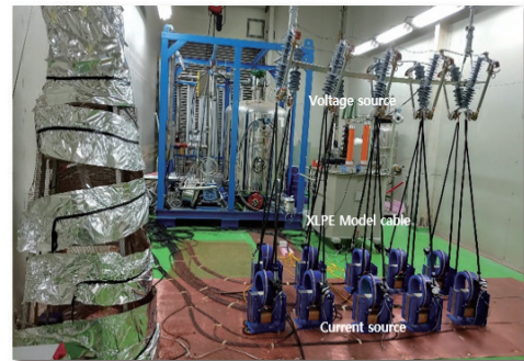
HVDC 전력케이블의 가속열화 장치
