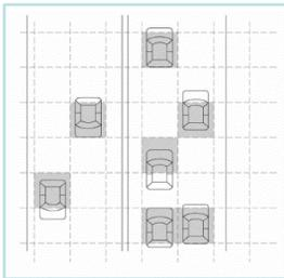
**도로의 교통량 분포 측정수단(20)은 촬영장치에 의해 촬영되는 도로 내의 자동차가 일정한 간격선에 의해 구획되는 영역 내에 캡처되는 경우, 자동차로 인식되도록 프로그래밍 됨으로써, 촬영장치에 의해 촬영되는 도로 내의 자동차 분포량을 자동으로 측정하도록 구성됨**
