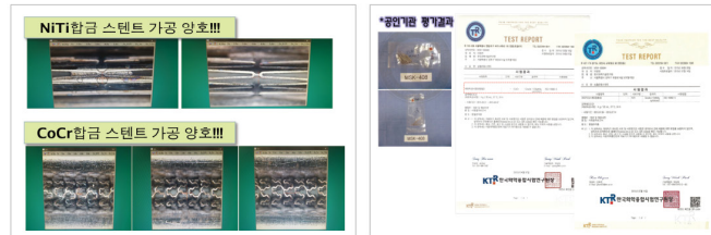
미세튜브 스텐트 가공 및 생체적합성 시험 만족
