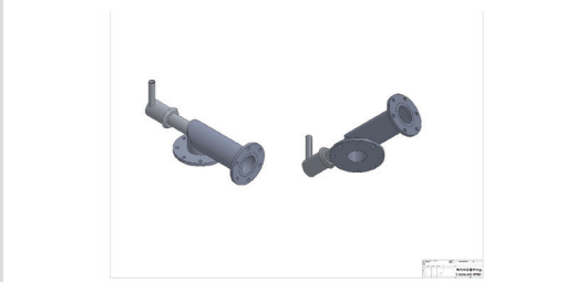
플라즈마 화염을 선형 화염으로 변화시키는 Elbow Nozzle ▲
