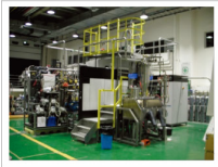
분위기 제어 (Carrier gas 산소농도 제어) 산소/Ar혼합가스 사용
