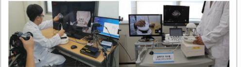
[대전과 대구를 연결하여 원격 초음파 영상진단 시스템을 테스트, 사람 간을 모사한 모형 위에 초음파 영상진단 장치와 연결된 슬레이브 로봇을 올려두고 초음파 영상을 전송]
