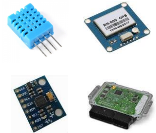
3개의 센서 및 ECU를 사용한 노면상태 판별
