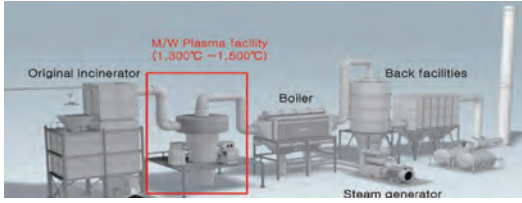
플라스마를 이용한 배가스 개질 장치 구성도 ▲
