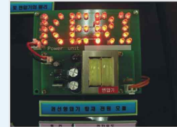
권선형 변압기 전원
