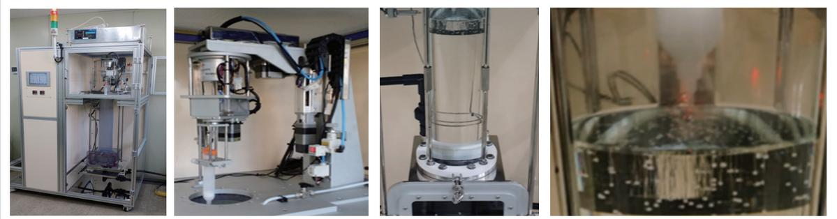
증식재 페블 성형 자동화 장치, 페블 제조 능력(Li<sub>2</sub>TiO<sub>3</sub>) : 50 Kg/year ▲
