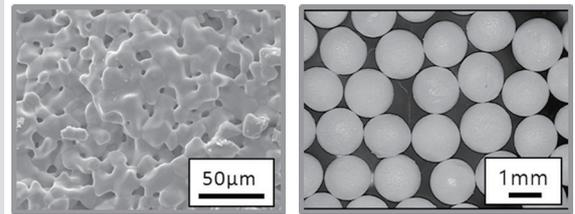
Li<sub>2</sub>TiO<sub>3</sub> 페블의 형상 및 미세구조 ▲
