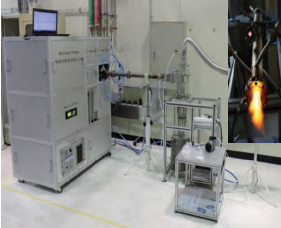
마이크로웨이브 플라즈마를 이용한 난분해성 폐가스를 분해하는 장치 ▲
