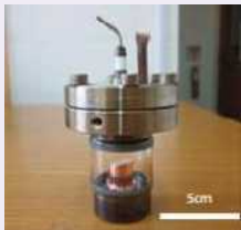
〈탄소나노튜브 에미터 기반 진공패키징 엑스선원〉 〈전계방출 전자빔의 3차원 모델링 및 해석〉
