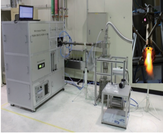
마이크로웨이브 플라즈마를 이용한 난분해성 폐가스를 분해하는 장치 ▲
