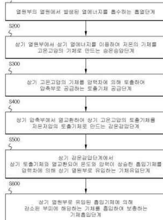
[압력차를 이용한 자연유도방식의 열교환방법의 일 실시예]
