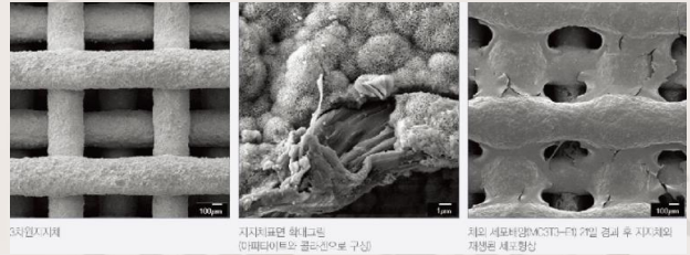
3차원지지체 지지체표면 하이드록시apatite(하이드록시아파타이트)를 골기질성분으로 구성 세라믹 세라믹(ACTG-4) 2차 코팅 후 지지체의 재생용 세라믹형상
