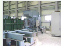
조류발전용 500kW 동기발전기 제어용 전력 변환장치 시제품 (2009조류발전소 설치/ 2년 실증완료/ 발전 중)
