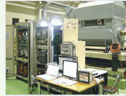
풍력발전용 2.4MW권선형유도발전기 제어용 전력변환장치 시제품(국내최대/전부하 실험완료)
