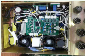
군용 UPS용 저전압/대전류 배터리 충전기
