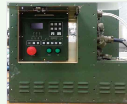
양방향 DC-DC 컨버터를 적용한 군용 UPS 시작품
