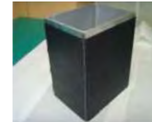
<CFRP 및 EMI 차폐 소재를 감은 튜브몰드>
