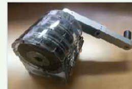
모듈화된 발전기 사진 : 50W 발전기 모듈을 결합하여 100W 발전기를 구성
