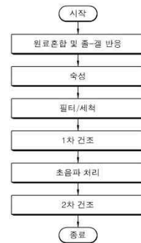
[고비표면적 및 고결정성을 갖는 나노기공 광촉매 제조 방법을 나타낸 공정 순서도]
